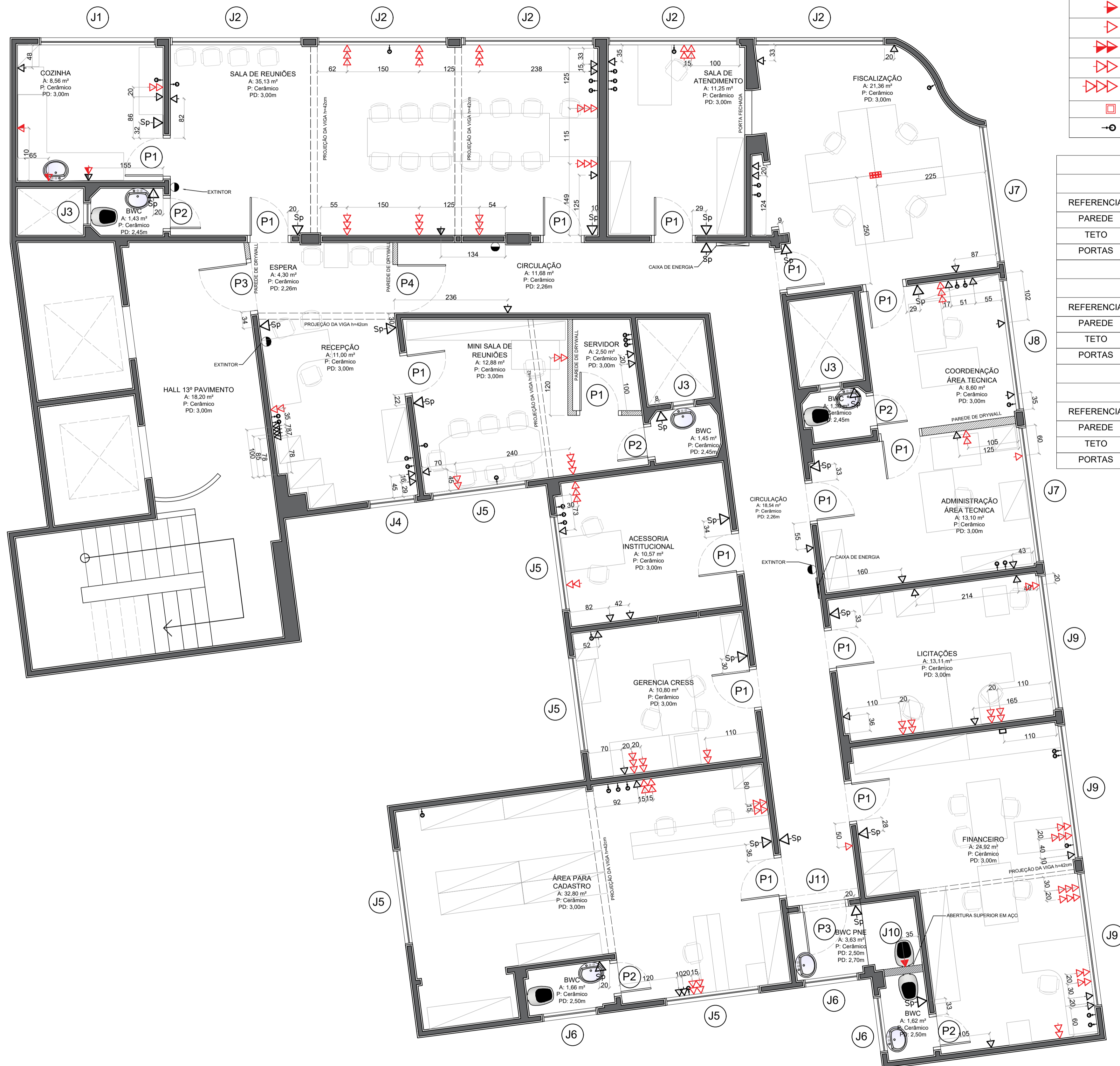
PLANTA BAIXA - ELÉTRICO BAIXO 13º PAV ESCALA: 1/50
